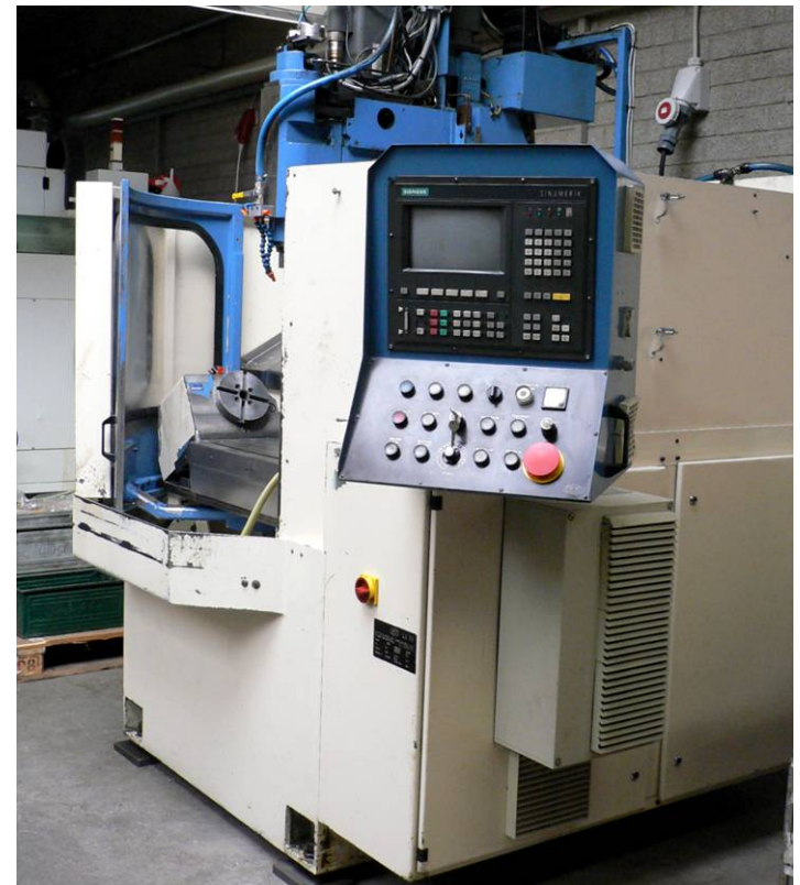
AXA CB-0, 3 Achsen mit Siemens Sinumerik Steuerung
