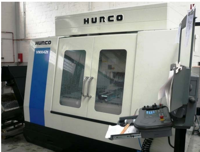
Fräszentrum HURCO VMX 42t, 3 Achsen mit WinMax- Steuerung
